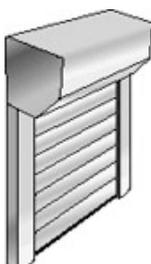
Les volets roulants se posent en un seul bloc sur la façade. Cette installation simplifiée fait des volets roulants monoblocs des produits idéaux pour la rénovation
