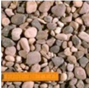
Le drainage peut se faire par " couche ", sous une dalle par exemple ou, d'une manière plus linéaire, sous forme de drains filants le long de murs ou de fondations par exemple.
