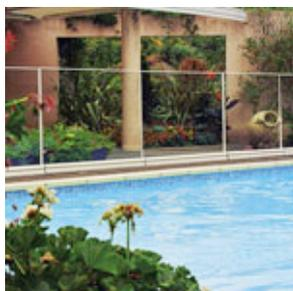
**Les remplissages sont en verre feuilleté de 10 mm d'épaisseur et sont enchâssés dans un seuil en aluminium vissé dans le sol, sans poteau vertical.** L'accès au bassin s'effectue par un portillon "coulissant" sécurisé, à manoeuvre à deux mains par deux loquets espacés de 1 mètre. Possibilité d'intégration du portillon battant. En option, des capteurs intégrés dans le seuil déclenchent une alarme en cas de tentative de franchissement.
